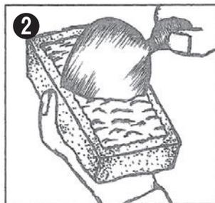
接着面にモルタルを充分塗り付けて下さい。塗むらなく、必ず全面に均一に練りつけて下さい。
