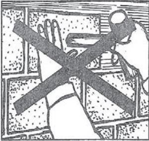
※「壁面側のみ」にモルタルを塗った「圧着貼り」は脱落の原因となりますので絶対に行わないで下さい。
