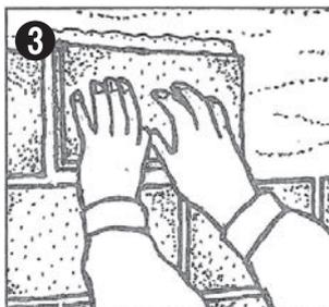
壁面に強くすりこむように貼り付けます。壁面側にもモルタルを塗る改良圧着張りをして頂くと、さらに強固な接着となります。接着剤で貼り付けられる際も、必ずもみ込むように貼付下さい。
