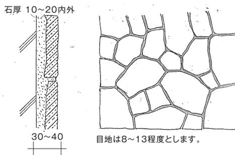
混合モルタルは、ダンゴ貼りで20Kg以上の圧力で練り圧着をして下さい。
