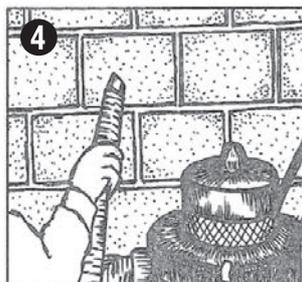
貼り付け後、ネオエックスを充分乾燥させ、その後に表面の砂を真空掃除機やブラシ等で掃除を行って下さい。特に、内装材として施工された場合は落ちなくなるまで丁寧に掃除を行って下さい。※濡れたままで清掃を行うと乾燥した後に砂が落ちてきます。
