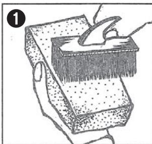
接着不良の原因となるので、ネオエックスの接着面を掃除機などでよく清掃した後、ドライアウト防止のため必ず適度に水で濡らして下さい。
