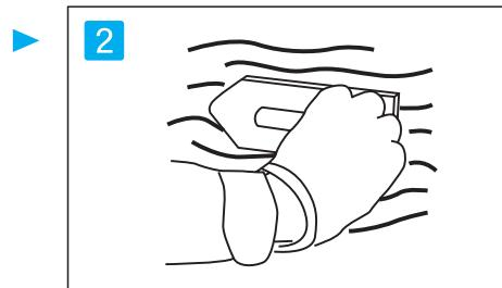
躯体に貼り付けモルタルを3~5mmの厚さに、30分程度で貼り材ができる面積に塗ります。
