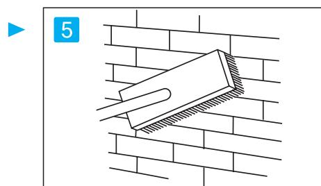
貼り付けは改良圧着貼りで最下段より積み上げていきます。また、ビープラートを用い、十分に圧力をかけて貼って下さい。
