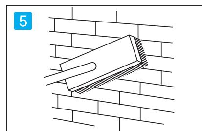
石に付着したモルタル粉は少し硬化してからブラシで搔き落とし、その後、すぐに水を含ませたスポンジ等で完全に拭き取って下さい。
