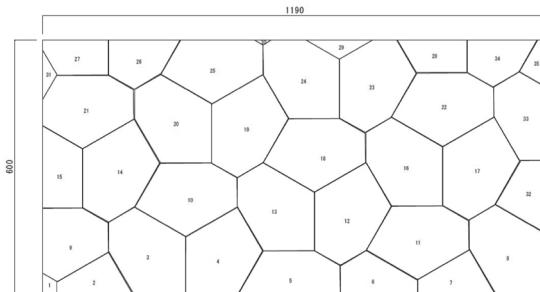
・手加工品の為、寸法誤差がございますのでクサビ、養生テープを使いながら隙間を調整して下さい。
