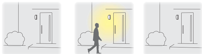
①周囲が暗くなると人感センサーが待機中になります。 ②人が来ると100%点灯します。 ③人が離れると約1分後に消灯します。
