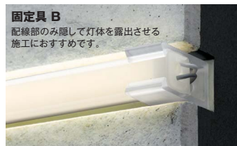
壁面上に設置する場合、溝を設けて固定具Bを取り付けることにより結線スペースを隠し、きれいに取ることが出来ます(溝幅や狭かつ溝が深いとラインライトが外せないでください)。
