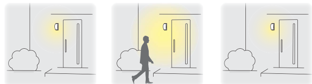
①周囲が暗くなるとほんのり点灯します。 ②人が来ると100%点灯します。 ③人が離れると約1分後にほんのり点灯に戻ります。
