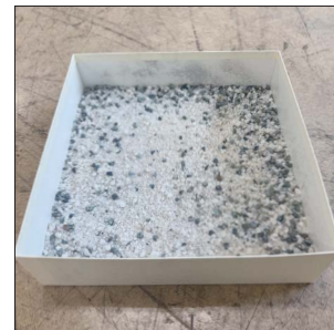
⑥ 硬化するまで乾燥養生します(夏季10時間以上、冬季24時間以上)。
