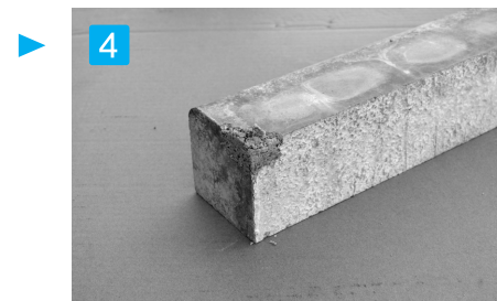
均し 充填材の硬化の進み具合を見ながら金コテを使って形を作っていく。
