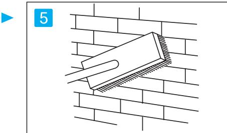
石に付着したモルタル粉は少し硬化してからブラシで搔き落とし、その後、すぐに水を含ませたスポンジ等で完全に拭き取って下さい。
