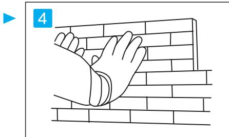
貼り付けは改良圧着貼りで最下段より積み上げていきます。また、ピラー板を用い、十分に圧力をかけて貼って下さい。
