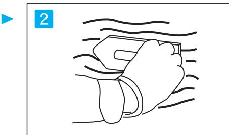
躯体に貼り付けモルタルを3~5mmの厚さに、30分程度で貼り材を貼ることができる面積に塗ります。
