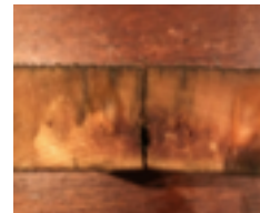
ケボニーデッキ材(屋外5年)断面 防腐薬剤欧州赤松(屋外5年)断面および表面
