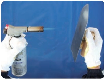
バーナーで熱を加えると、金ゴテの滑りが良くなります。
