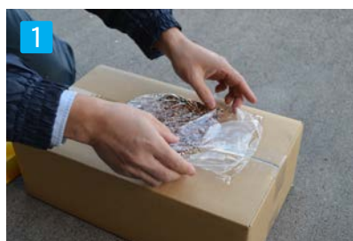
1 デザインピースにラップを被う ※生コンが付着しないようにしっかり包むように被う。
