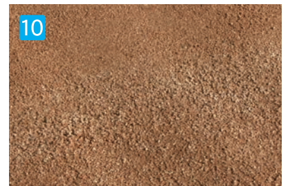
12 完全硬化 夏場:約1週間 冬場:約2週間 (表面の砂利は徐々にとれますが強度は変わりません。)
