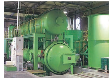
AZN処理(乾式加圧注入防腐・防蟻処理工法)装置 (写真提供: 兼松サステック株式会社)
