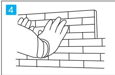
貼り付けは改良圧着貼りで最下段より積み上げていきます。また、ピブレードを用い、十分に圧力をかけて貼って下さい。
