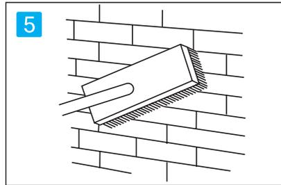
石に付着したモルタル粉は少し硬化してからブラシで掻き落とし、その後、すぐに水を含ませたスポンジ等で完全に拭き取って下さい。
