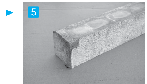
5 仕上げ 充填材の余分は引き取り仕上がり面を金コテを使って整える。
